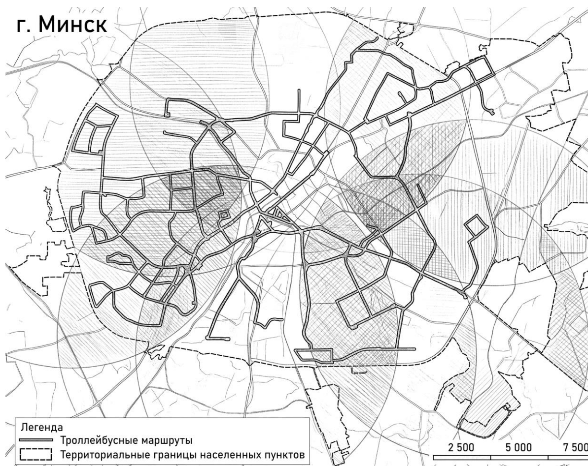
Рисунок 3 – Покрытие города Минска с учётом использования существующей КС из расчёта дальности запаса хода 15 км в сообщении «туда и обратно»
